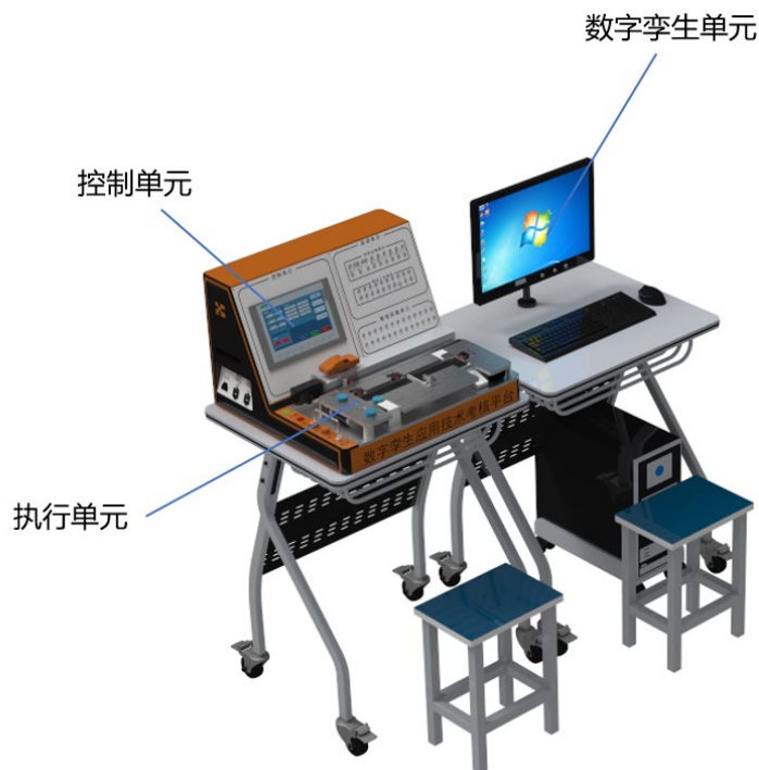
图3-1 竞赛平台结构示意图
